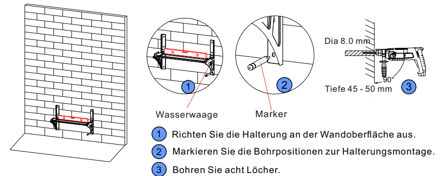
Abbildung 4-9: Bestimmung der Bohrpositionen für die Wandhalterung
